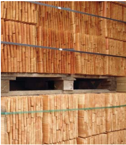
▲ Die unbearbeiteten Holzschindeln mussten vor der Verlegung in der Werkstatt zunächst in einem großen Zuber sorgfältig weichgekocht und anschließend entsprechend der komplizierten Geometrie des Zwiebelturms in einer speziellen Lehre gebogen werden
