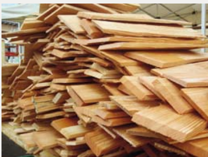
▲ Zur Fertigung der Holzschindeln werden ausschließlich wetterfeste Holzarten wie Zeder und Lärche verwendet
